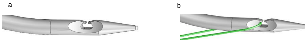
Εικόνα 2 : Κόκκος του οργάνου (α) και βρόχος του σύρματος έλξης που είναι τοποθετημένος στο μάτι (β)
