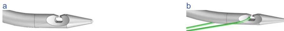
Figure 2 : Chas de l'instrument (a) et boucle du fil de traction monté sur le cha (b)
