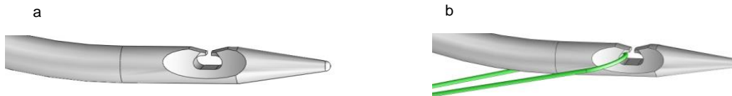
Abbildung 2: Instrumentenöse (a) und Schlaufe des Zugfadens an der Öse (b)
